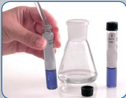
Wer an Küvettentests denkt, möchte einfach pipettieren, gegebenenfalls „kochen“ und messen. Genauso funktioniert auch der TOC-Küvettentest. Doch um richtige Ergebnisse zu bekommen, muss man – wie immer – Sorgfalt bei der Vorbereitung seiner Probe aufwenden! Und hier gibt es beim TOC Test ein paar nützliche Tipps für die Praxis:
